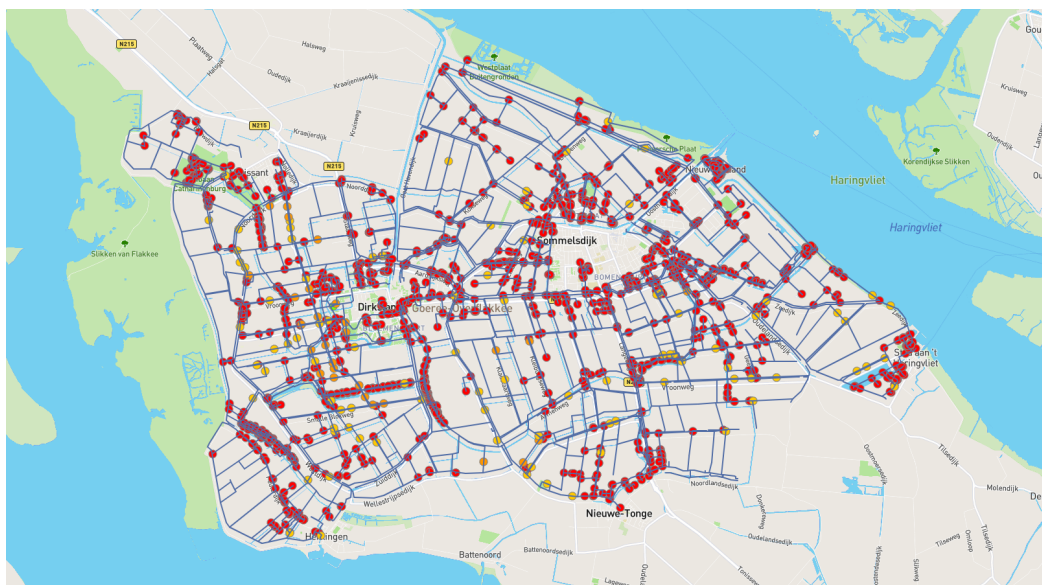
Figuur 5.3 Gegevensvalidatie van de profielen (HydroToolbox). Alleen de profielen die een rapportcijfer 8 of lager hebben gekregen zijn weergegeven
