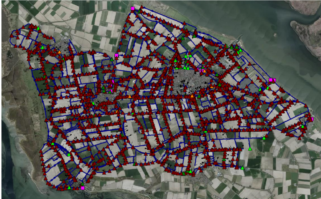
Figuur 6.2 Duikers (bruin), stuwen (lichtgroen), gemalen (oranje), afsluiters (donkergroen) en boundary nodes (roze) in het SOBEK-model. De blauwe lijnen zijn de watergangen
